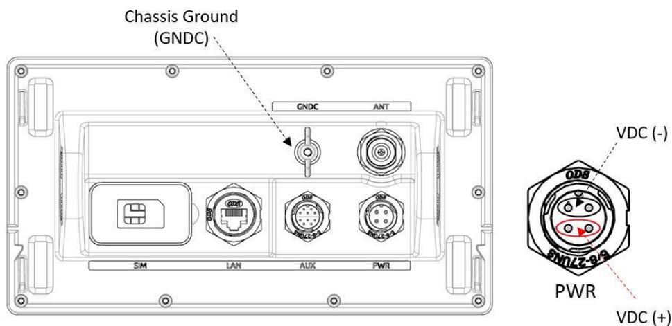
Figure 52: LT-3110S Control Unit (VDC(+), VDC(-), and GNDC)
